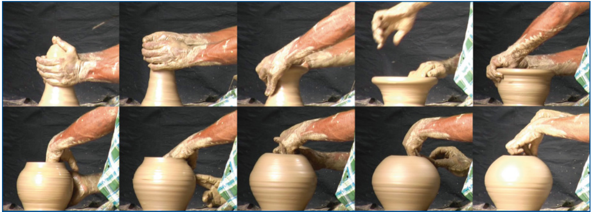
Figure 2 : Exemples de positions de main utilisées pour le tournage. Les images ont été extraites d'une vidéo d'un potier Multani produisant une sphère avec 2.25 kg d'argile (Gandon et al., 2013).
